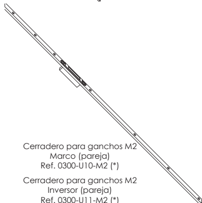
Cerradura de 2 ganchos (cerradura para puerta de calle de seguridad) Ref. 0300-STV-M2 (*) D/I
