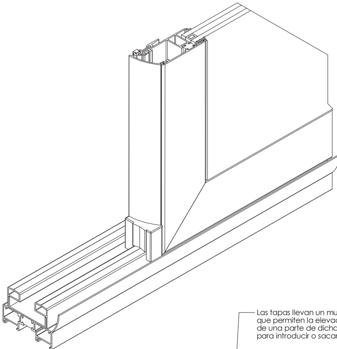
Las tapas llevan un muelle que permiten la elevación de una parte de dicha tapa, para introducir o sacar la hoja.
