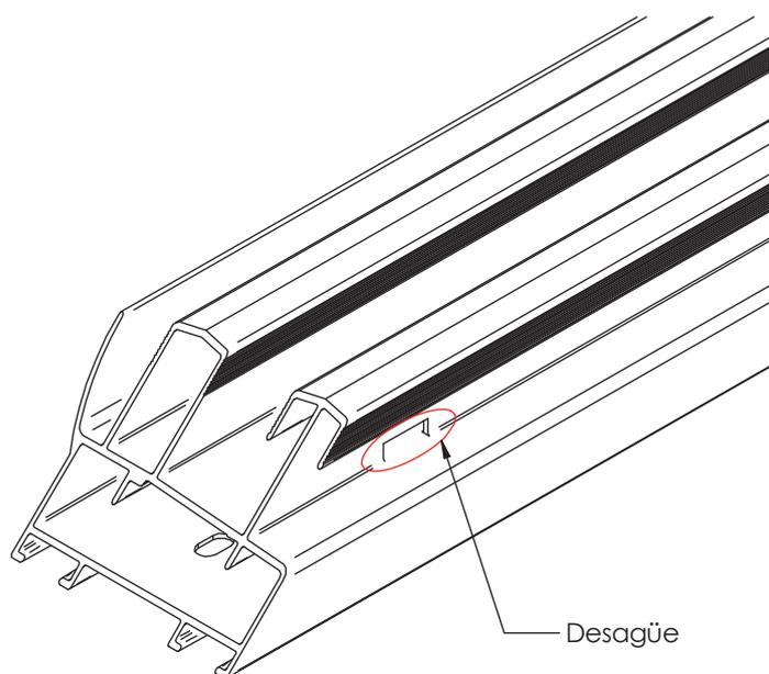
El desagüe debe ir colocado en el extremo del carril exterior (donde no tenemos hoja exterior con la ventana en posición cerrada).
